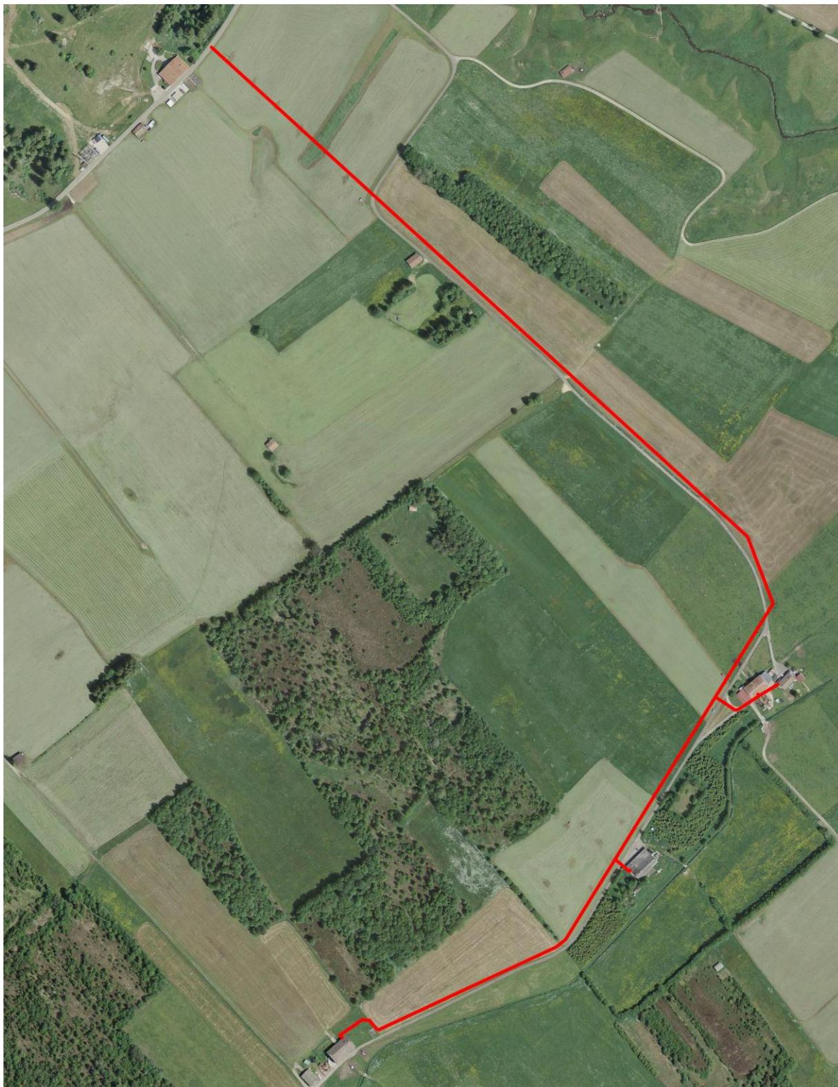
*Plan de situation « Sur Les Bieds » avec tracé de la nouvelle conduite d'eau*
